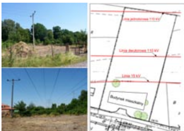
Rys. 3. Przykład lokalizacji budynku mieszkalnego w pobliżu linii elektroenergetycznych 110 kV
