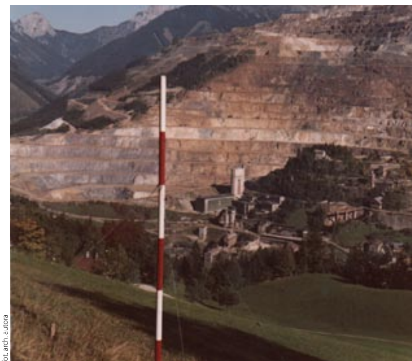
Rys. 1. Alpejska odkrywkowa kopalnia rudy żelaza Erzberg, długość frontów eksploatacyjnych wynosiła kilka kilometrów, rozpiętość odkrywki w pionie przekraczała 500 metrów
