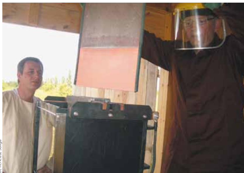
Pierwsza miedź elektrolityczna z elektrolizera Łaszczyńskiego w Parku Etnograficznym w Tokarni. Grubość warstwy ok. 0,23 mm
