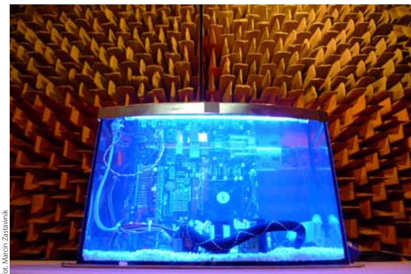
W oleju zanurzona jest płyta główna, procesor, zasilacz, karta graficzna i pamięć RAM. Komputer działa bez zarzutów prawie dwa lata.
