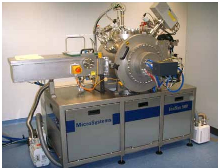
System do napylania cienkich warstw metali i izolatorów oraz trawienia jonowego zainstalowany w strefie pomieszczeń czystych
