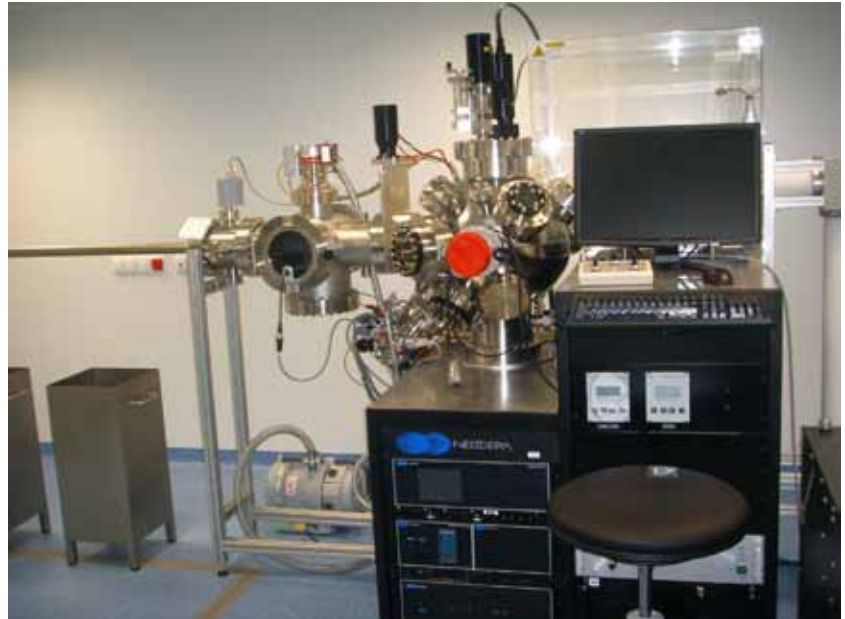
System do wytwarzania złożonych układów cienkich warstw metodą ablacji laserowej
