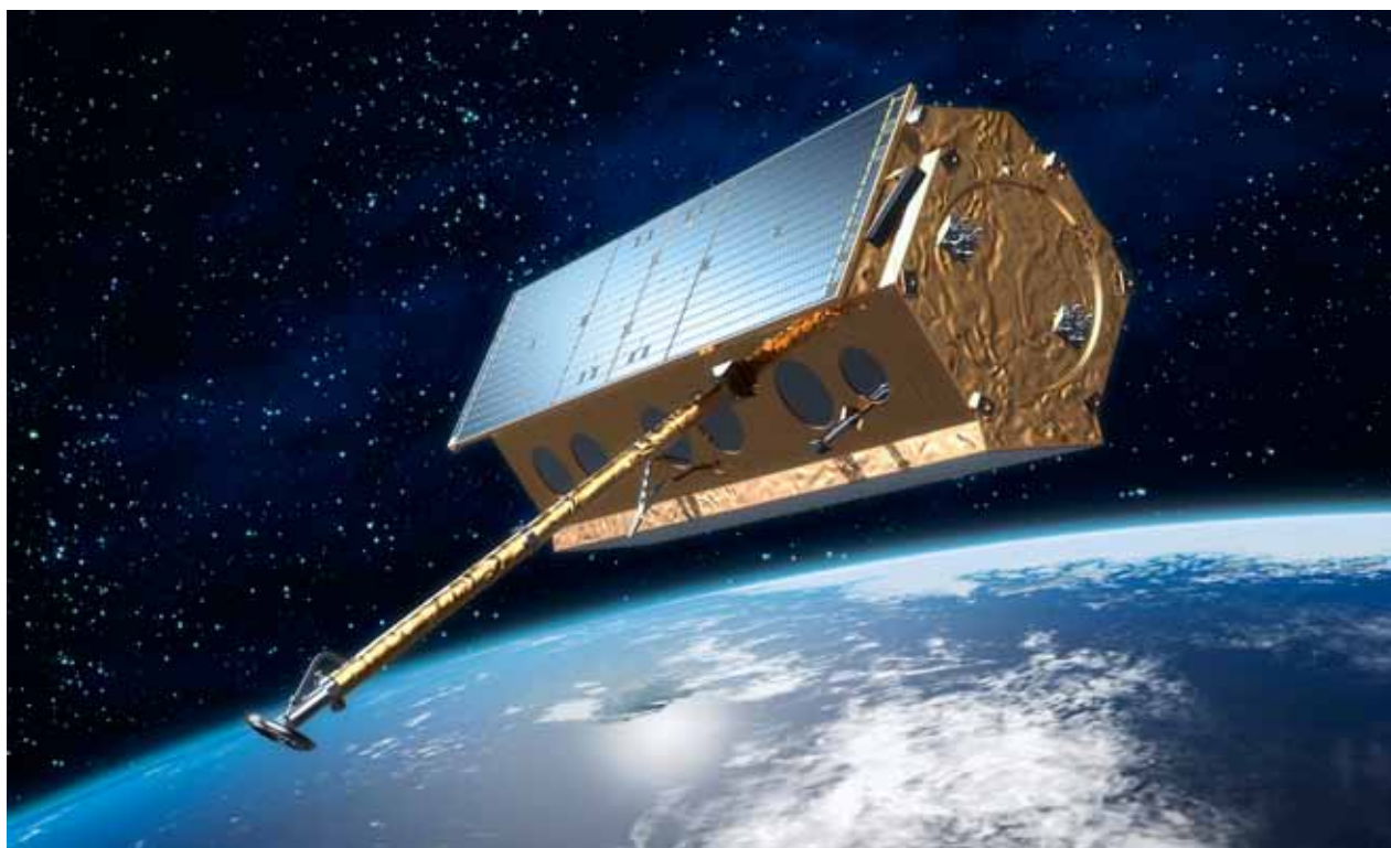
Satelita TerraSAR-X Niemieckiej Agencji Kosmicznej wyposażony w radar SAR
