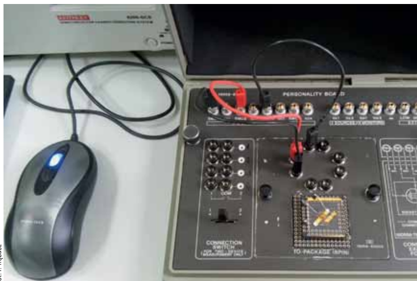
Kolejna wersja sztucznej synapsy w czasie testów elektrycznych.
