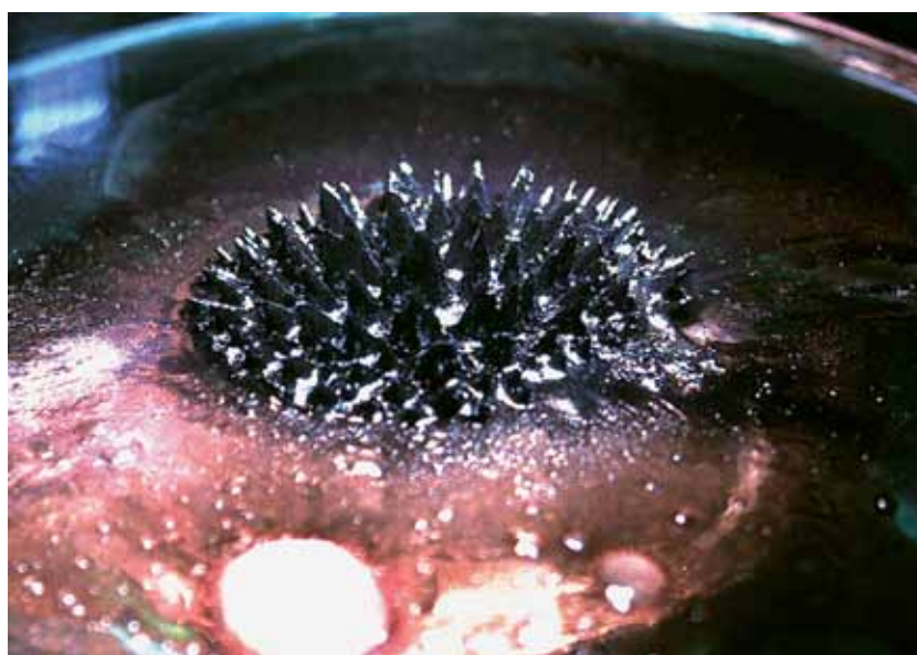
Efekt oddziaływania wytworzonego w naszym laboratorium ferrofluidu z magnesem, kształt i rozmiar kolców (ang. spikes) zależą od linii sił pola magnetycznego. Po usunięciu magnesu kolce przestają być widoczne.
