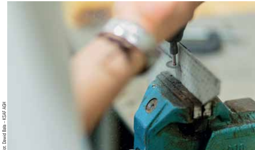
Docinanie próbek kompozytów do badań wytrzymałościowych
