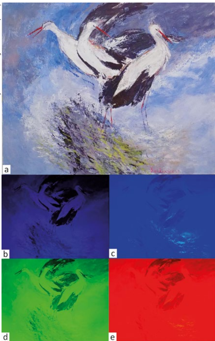
Obraz z cyklu „Bociany” Marii Bińkowskiej-Kopczyńskiej („Pestki”) i jego analiza fotometryczna: zdjęcie w świetle białym (a) oraz przy oświetleniu monochromatycznym: 385 nm (b), 465 nm (c), 520 nm (d) i 620 nm (e)
