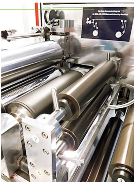
Rys 13. Linia półtechniczna do produkcji ogniw 18650 typu Li-ion i Na-ion, Centrum Energetyki AGH
