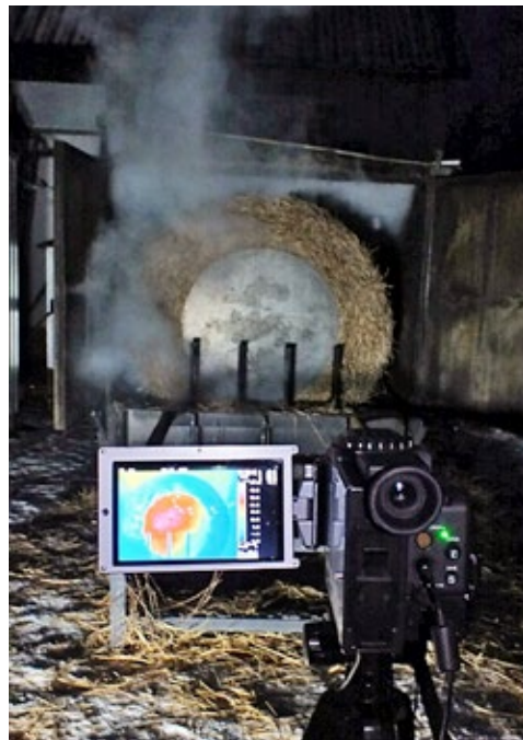
Pomiar termowizyjny powierzchni suszonego balotu słomy za pomocą kamery termowizyjnej
