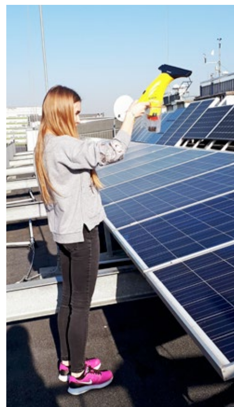
Pobór próbek pyłu zdeponowanego na panelu fotowoltaicznym
