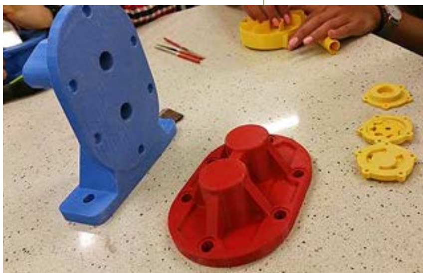
Modele pomp wytwarzane metodą druku 3D
