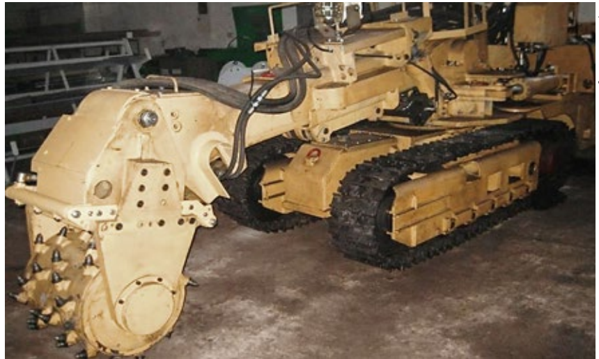
Spągoładowarka z wymiennym osprzętem do przybierki spągu
