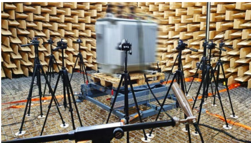
rys. 2. Widok stanowiska badawczego mocy akustycznej transformatora w komorze bezchowej
