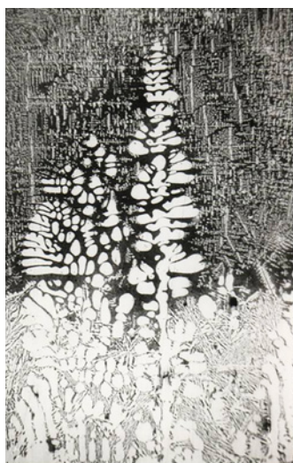
rys. 4. Dendryty \alpha (Al) kształtowane na froncie krystalizacji siluminu i otrzymane w urządzeniu do kierunkowej krystalizacji typu Bridgmana fot. Katedra Inżynierii Stopów i Kompozytów Odlewnych na Wydziale Odlewnictwa]
